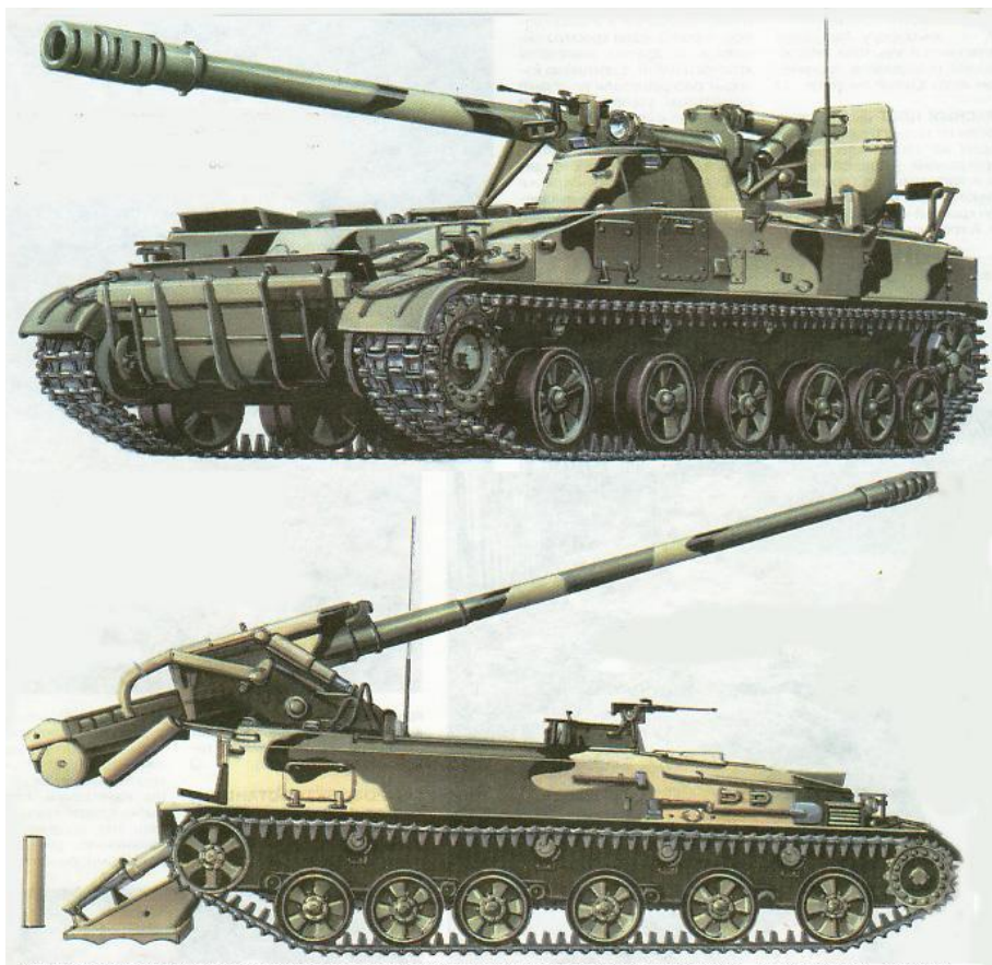
152-мм самоходная пушка повышенного мощества 2С5 "Гиацинт": вес в походном положении - 28,2 т, скорость - 60 км/ч; вооружение: пушка 2А37, боекомплект - 30 выстрелов, масса снаряда - 43
