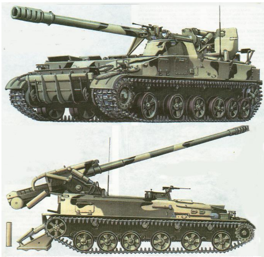
152-мм самоходная пушка повышенной мощности 2С5 "Гигант": вес в походном положении - 28,2 т, скорость - 60 км/ч; вооружение: пушка 2А37, боекомплект - 30 выстрелов, масса снаряда - 43
