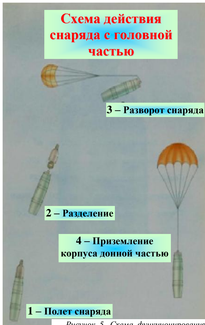
Рисунок 5. Схема функционирования снарядов СК при стрельбе из самоходной установки 2С7 «Пион».
